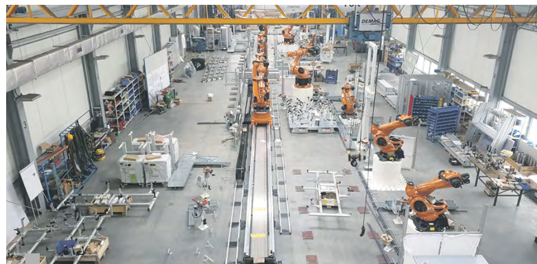
Hala montażowa o powierzchni 1400 m 2 wyposażona w suwnicę oraz zaplecze maszynowo narzędziowe
