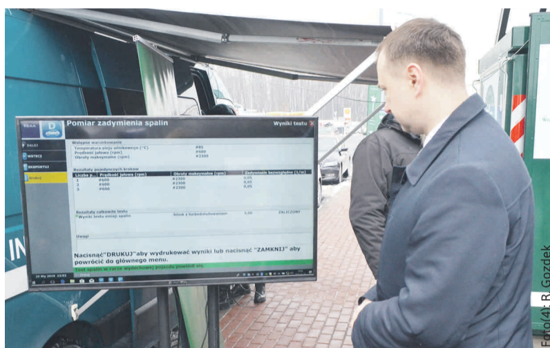
Urządzenie w łatwy sposób umożliwia wykonanie m.in. pomiaru zadymienia spalin badanych samochodów.
