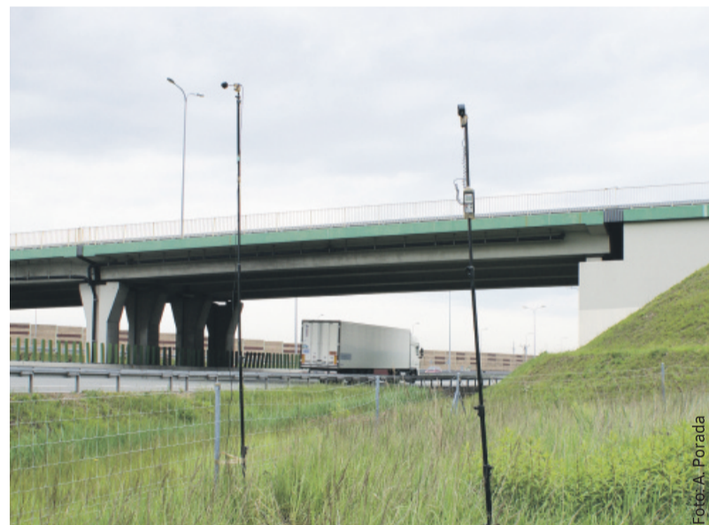
Pomiary poziomu hałasu prowadzono już wcześniej, obecnie wykonywano pomiary kontrolne, niezbędne do prac projektowych.
