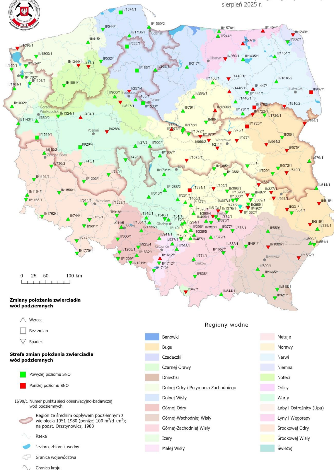
Ryc. 4. Zmiana położenia zwierciadła wody podziemnej w objętych analizą punktach sieci obserwacyjno-badawczej wód podziemnych w sierpniu 2025 r.
